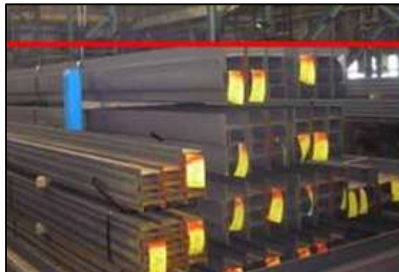
Materiały składowane w stojakach o charakterze jednorodnym (np. dwuteowniki, paczki dwuteowników itd.) mogą być składowane powyżej wysokości regału, ale w sposób zapewniając stabilność stosu oraz minimum połowa wystającego materiału musi zawsze znajdować się poniżej górnej krawędzi regału.
