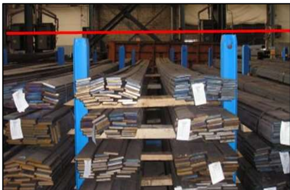
Materiały składowane w stojakach o charakterze paczek niejednorodnych (np. w postaci paczek płaskowników, prętów itd.) muszą być składowane do wysokości nie wykraczającej poza wysokość regału.
