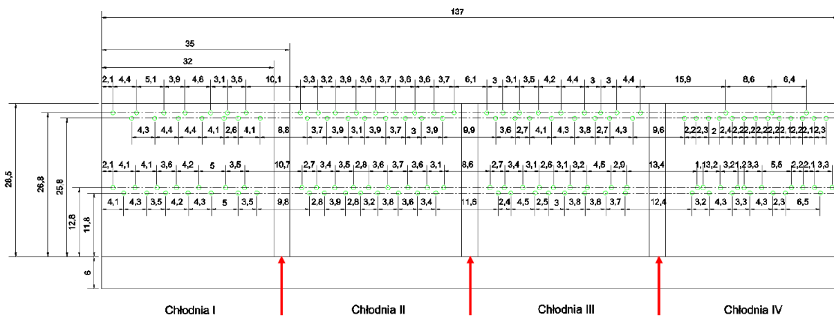
Rysunek 2. Schemat obecnego rozmieszczenia wentylatorów pod chłodnią I÷IV (SPRAWOZDANIE z pracy B0 1626 01, część II)
