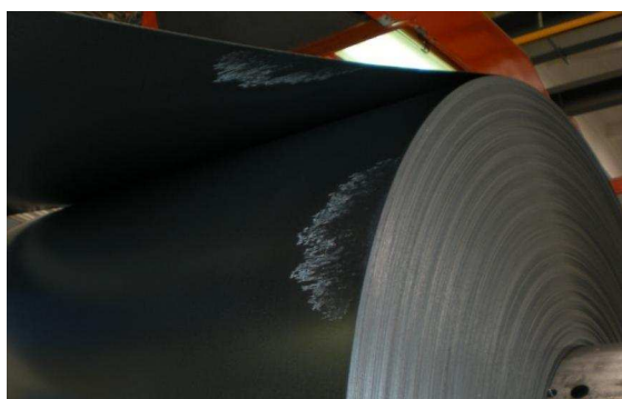
TYPOWY PRZYKŁAD BIAŁEJ KOROZJI NA KRĘGU
